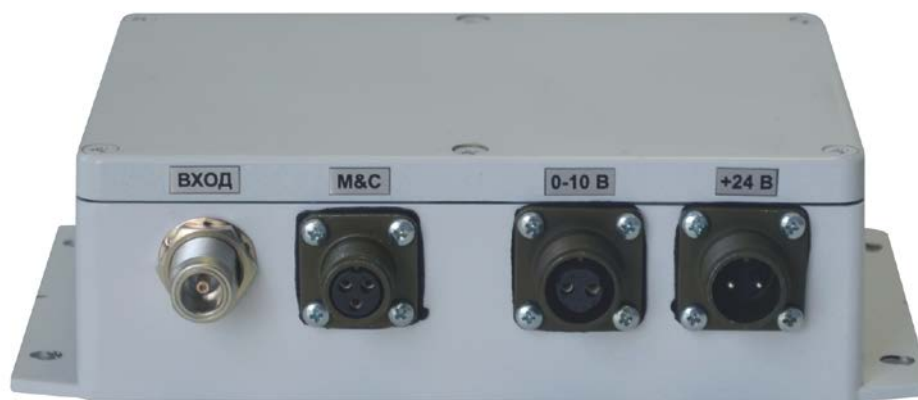
Рисунок 1.1.2 – Внешний вид приемника наведения ПСН-А со левой боковой стенки изделия
