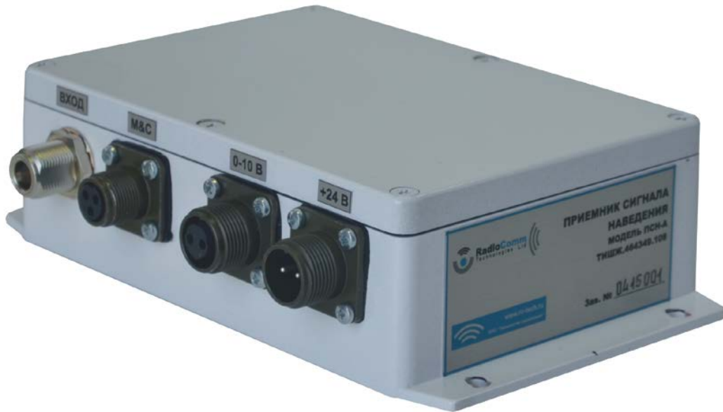
Рисунок 1.1.1 – Внешний вид приемника наведения ПСН-А со стороны левой боковой и нижней стенки изделия
